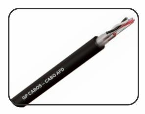
Características: Formado por fios de cobre eletrolítico estanhados, têmpera mole, com encordoamento classe 4 ou 5 (NBR 280), isolados em polietileno, torcidos paralelamente, blindagem individual em aluminizada e blindagem coletiva em fita de poliéster, drenos flexíveis em cobre estanhado e cobertura externa em PVC sem chumbo, resistente a chama, na cor preta.
