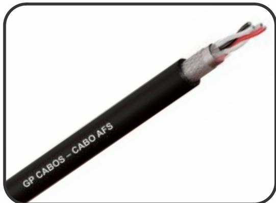
**Características:** Formado por fios de cobre eletrolítico estanhados, têmpera mole, com encordoamento classe 4 ou 5 (NBR NM 280), isolados em polietileno, torcidos paralelamente, fita separadora em poliéster, blindagem coletiva em fita aluminizada + trança em cobre estanhado e cobertura externa em PVC sem chumbo, resistente a chama, na cor preta.
