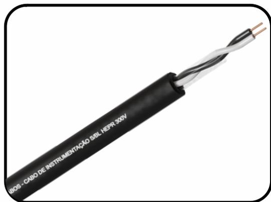
**Características:** Formado por fios de cobre eletrolítico nu, têmpera mole, com encordoamento classe 4 ou 5, isolados em composto extrudado termofixo de borracha etileno-propileno (HEPR/XLPE) 90°C, torcidas paralelamente e enfaixados com fita separadora de poliéster aplicada helicoidalmente, sem blindagem e cobertura externa em PVC especial classe 105°C não propagante a chama na cor preta.
