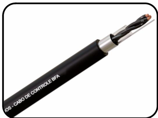
**Características:** Formado por fios de cobre eletrolítico nu, têmpera mole, com encordoamento classe 5 (NBR NM 280), isolados em PVC (composto polivinílico) sem chumbo, resistente a chama, torcidos paralelamente e enfaixados com fita separadora de poliéster aplicada helicoidalmente, blindagem com fita de poliéster aluminizada aplicada helicoidalmente, condutor dreno estanhado de 0,50 mm<sup>2</sup> e cobertura externa em PVC sem chumbo, resistente a chama, na cor preta.
