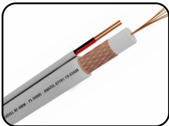
**Características:** Fios em alumínio cobreado encordoados, isolados em polietileno, com blindagem em malha de alumínio cobreado. Possui dois condutores em cobre eletrolítico nú isolados em polietileno agregados a capa paralelamente para alimentação da câmera. Capa externa em PVC na cor branca ou preta não propagante a chama.
