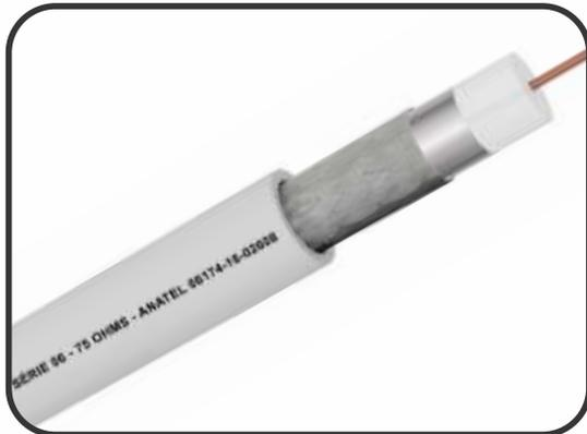
**Características:** Fio de aço cobreado, tempera dura, isolados em polietileno expansor incolor, com blindagem em fita aluminizada aplicada longitudinalmente e malha trançada em alumínio. Capa externa em PVC na cor branca não propagante a chama.
